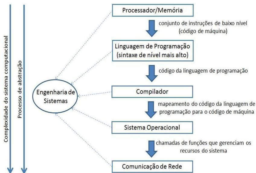
**Figura 2** – Diagrama de um sistema computacional completo.
